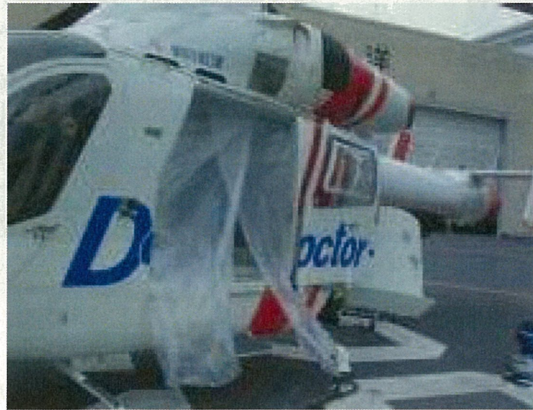
図①ヘリコプター内部（内壁）のビニールを貼付し防護した外側から見た状況（扉を開いた状態）
